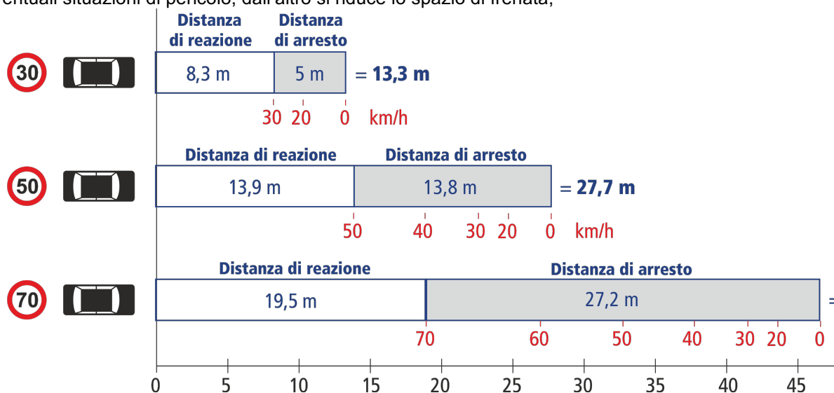
Fig. 5 Grafico distanze arresto in relazione ai km/h
